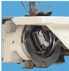
Barelový chapač zajišťuje dostatečnou zásobu těch nejsilnějších nití.
