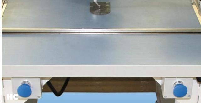
Ovládání stroje pomocí tlačitek – používá se jako bezpečnostní prvek pro ochranu obsluhy. Stroj se spustí současným stiskem dvou tlačitek. Toto vybavení lze dodat pouze se stroji s šicí plochou 350 x 250 mm a větší.
