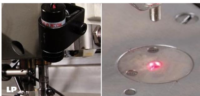
Laser – používá se pro provedení kontroly umístění vzoru vůči podávacímu rámečku nebo šablóně. Tím je zabráněno nechtěnému mechanickému poškození stroje z důvodu špatné velikosti rámečku vůči vytvořenému vzoru nebo kvůli jeho osovému posunu.
