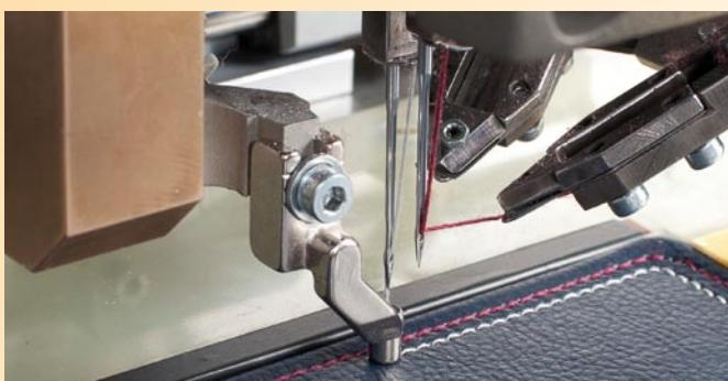
Provedení stroje GPS/G-10060GD umožňuje automatickou výměnu dvou jehel a šítí dvěma barvami nitě při jednom upnutí šitého díla. Dochází ke zvýšení produktivity výroby a snížení počtu strojů.
