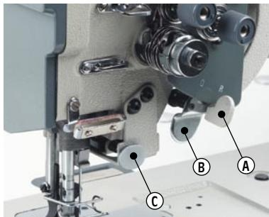
Vypínání jehel se provádí pomocí páky „A“. Jejich opětovné zapnutí zajistí stisk tlačítka „B“. Tlačítka „C“ slouží k ručnímu zpátkování a lze jej použít i pro pootočení stroje vzhledem o 1/2 otáčky.
