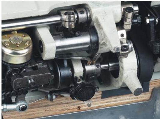
Olejové čerpadlo zajišťuje rovnoměrnou dodávku oleje do všech mazacích míst.
