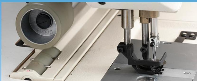
Odtahový válec pomáhá zajistit rovnoramenné podání šitého díla. Na objednávku se dodávají válce s různým průměrem a povrchovou úpravou: P – polyuretan hladký, S – ocel vroubkovaná, T – silon vroubkovaný.
